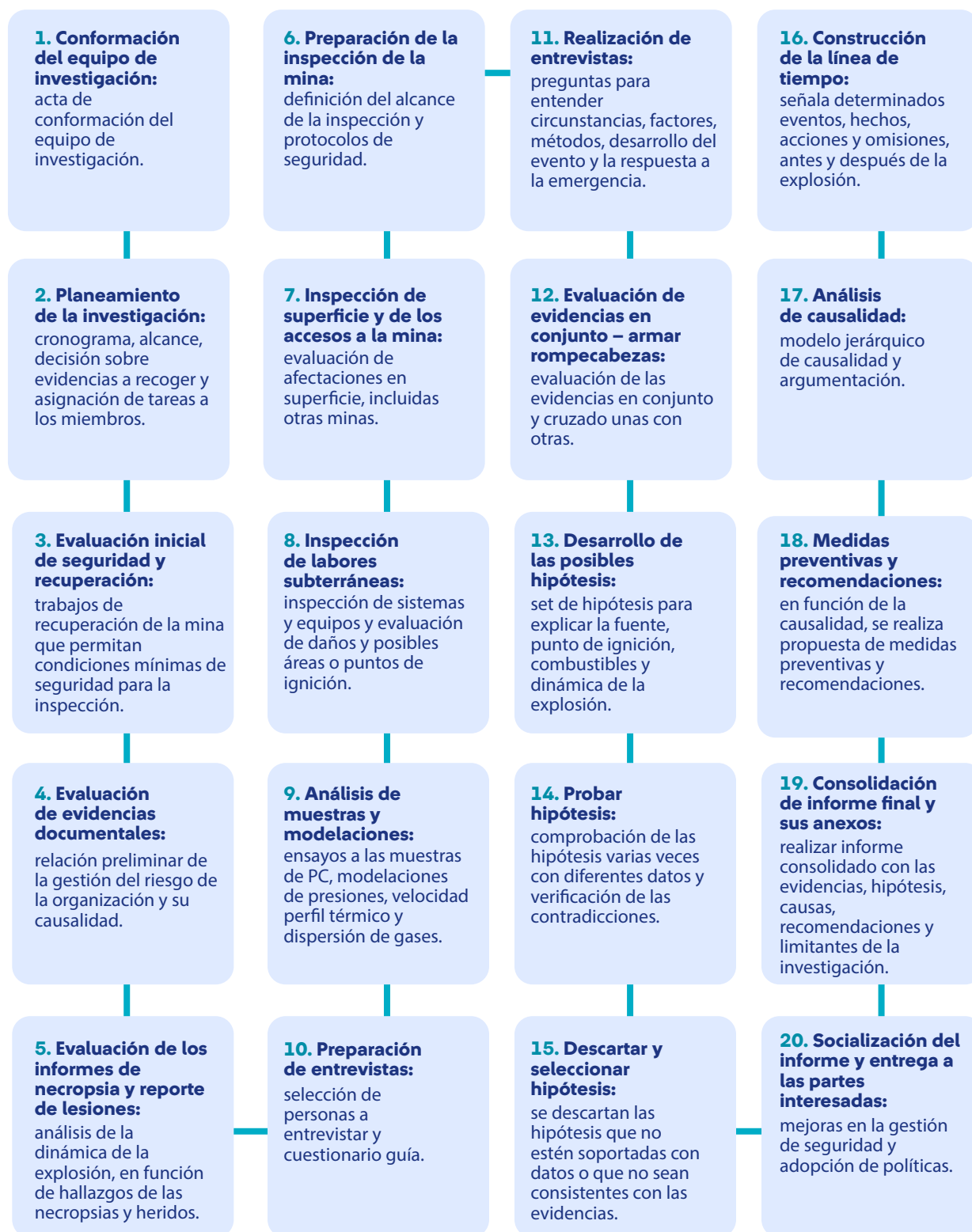
Gráfica 9. Protocolo de 20 pasos en la investigación de explosiones de metano y polvo de carbón. Fuente: Gheorghe, GC, 2023
